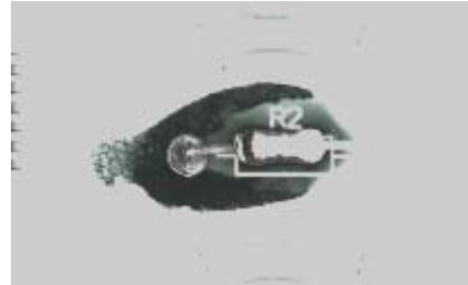
塗布されていないエリア
